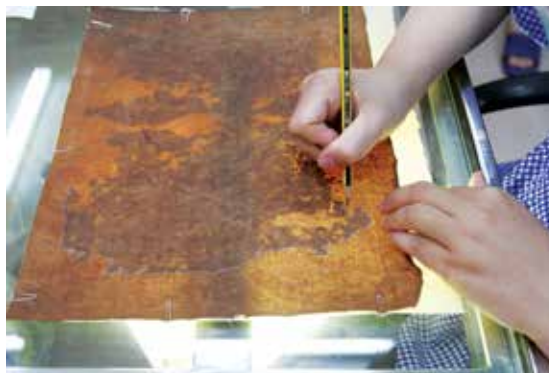
Hình 3. Loại bỏ lớp giấy bìa bám dính trên bề mặt, làm xuất lộ chữ ở trang dưới (Ảnh: Nguyễn Thị Lan)
